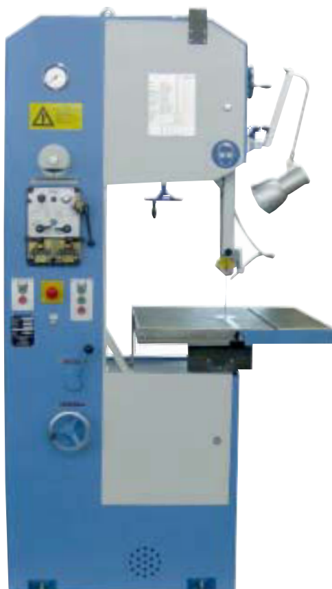
Abbildung mit Stumpfschweissapparat. Photo showing machine with saw blade butt-welding apparatus.
